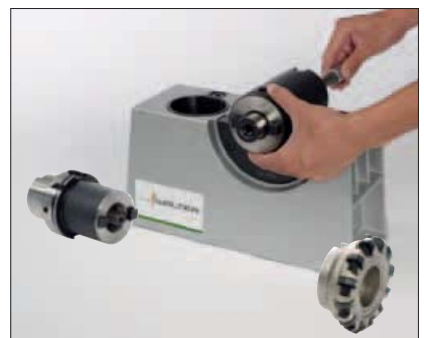
6. 用套筒扳手将接长杆和铣刀柄手动拧在一起。
